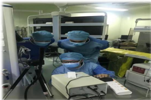
测尘埃粒子数（TSI尘埃粒子计数器）
