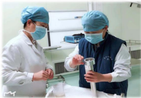
测菌落数（空气微生物采样器）
