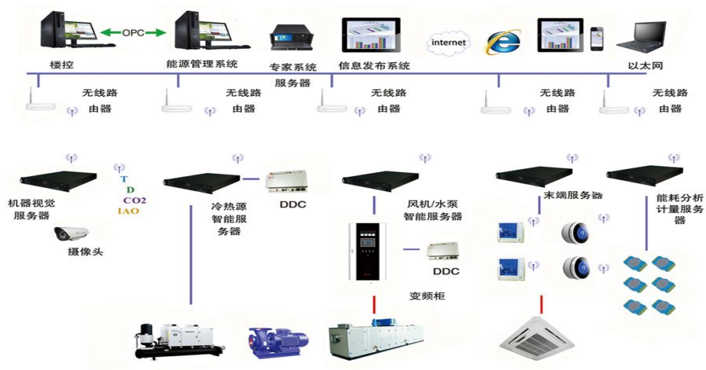
图 2 中央空调系统节能原理图
