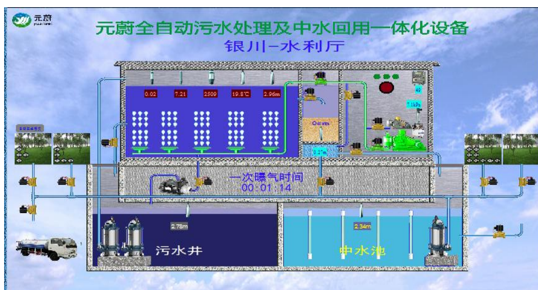
图 3 污水处理及中水回用设备运行示意图
